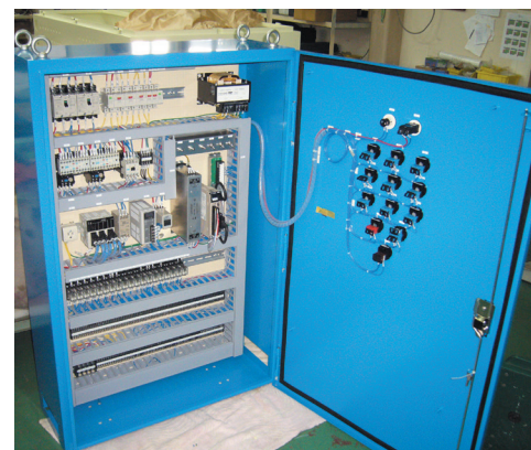
食品工場設備向けの制御盤
